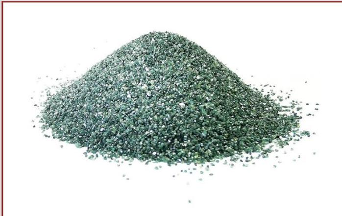
绿碳化硅磨料是一种磨削力强的喷砂介质。它比氧化铝、玻璃珠等常用的喷砂介质硬度都高，仅次于金刚石。即使对于坚硬的花岗岩、硬质光学玻璃、石英玻璃、硬质合金，也可以达到高效研磨的效果。一级绿碳化硅以99%以上绿碳化硅块料为原料，经酸洗、破碎、筛分等工艺制成。用于喷砂研磨的绿碳化硅颗粒均匀，可以达到一致的表面处理效果。
